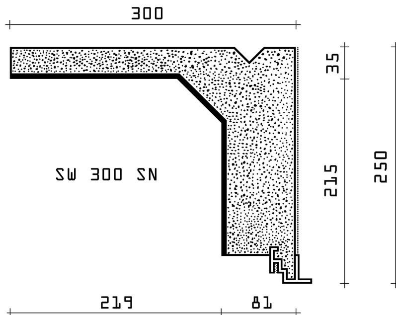
Serienmäßig haben alle Rolladenkästen der Typenreihe SW eine spezielle **Clip - Innenschiene** für den einfachen, schraublosen **EASY - CLIP - Deckelanschluss**, mit 15 mm Ausladung.
